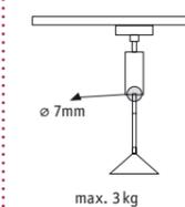
Zum Einbinden von Pendeln ohne URail Anschluss.
