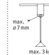
Zum Einbinden von Pendeln ohne URail Anschluss.
